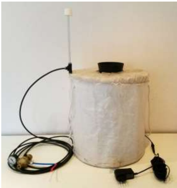
Abbildung 8: BG-Sentinel. Die Falle strömt einen künstlichen Lockstoff aus, der den Geruch eines Menschen nachahmt und so wirtsuchende Mückenweibchen anlockt. Um die Falle noch attraktiver zu machen, kann sie zusätzlich mit CO 2 ausgerüstet werden. Das CO 2 stammt aus der Sublimation von Trockeneis oder einer Gasflasche, die über ein Druckventil an die BG-Sentinel Falle angeschlossen wird. Über den Emitter (Stab mit weißer Kappe) strömt CO 2 aus.
