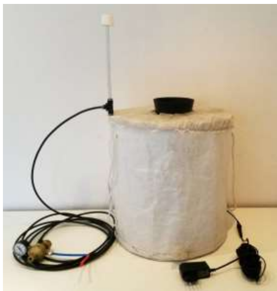
Figure 8: BG-Sentinel. Le piège émet un attractif artificiel qui imite l'odeur d'un être humain et attire ainsi les femelles du moustique en quête d'un hôte. Pour rendre le piège encore plus attrayant, il peut également être équipé d'émission CO 2 . Le CO 2 provient de la sublimation de la glace carbonique ou d'une bouteille de gaz, qui est connectée au piège BG-Sentinel par une vanne de pression. Le CO 2 sort par l'émetteur (bâton avec le bouchon blanc).
